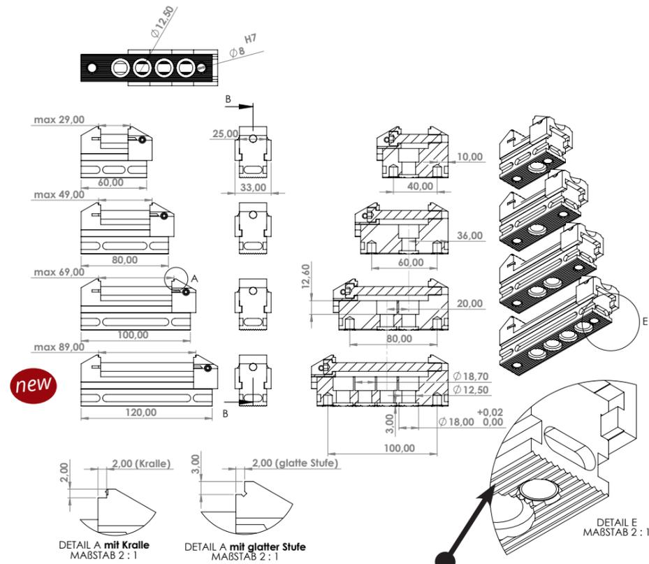
mit Verzahnung zum Einsatz auf SFT Spannschiene
